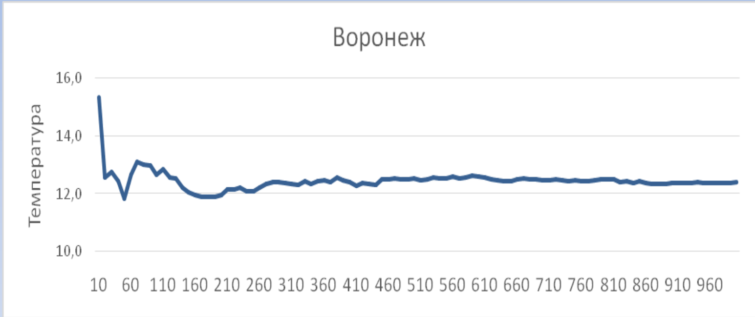
Рис. 1. Значения оценок математического ожидания температуры при расчетах по выборкам различного объема (пункт Воронеж)
